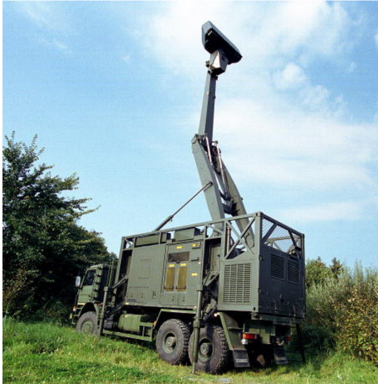
Figure 15: Saab GIRAFFE AMB radar, in truck-mounted mobile configuration [6].
